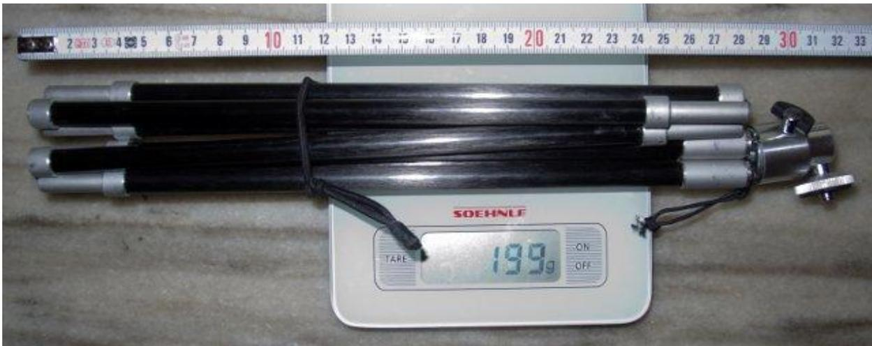
Jetzt ist das Kamerastativ zusammenpackbar auf 32cm und hat ein Gesamtgewicht von 199 Gramm. Ein Ziel war von Anfang an, dass ich das Stativ am [Rucksack](#) befestigen kann, und dieses hervorholen und versorgen kann, ohne den [Rucksack](#) abziehen zu müssen. Auf dem folgenden Bild sieht man das Stativ seitlich am [Rucksack](#)schultergurt befestigt:
