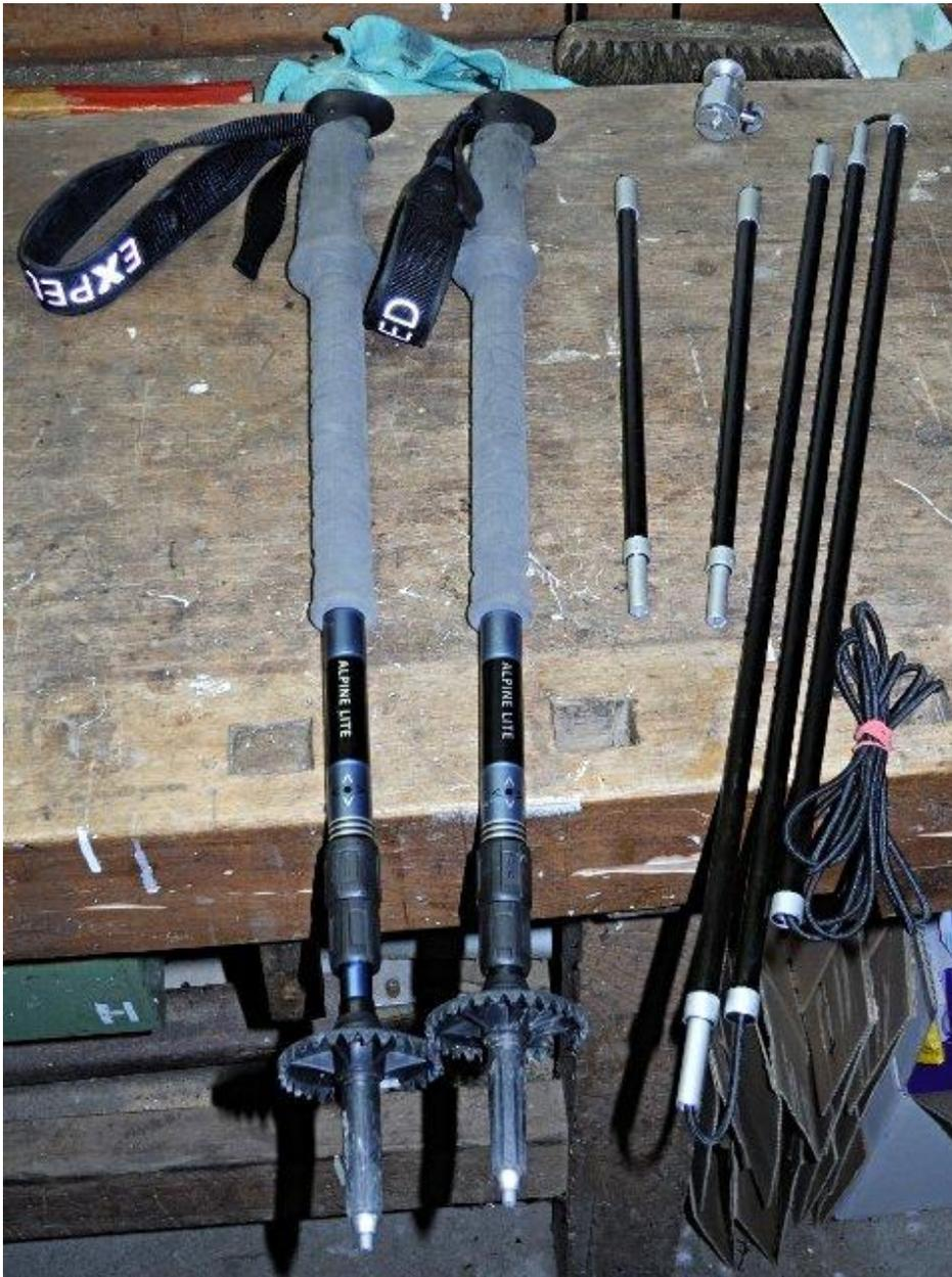
Mit einem Knopf am Ende der elastischen Kordel, und etwas das verhindert, dass der Knopf der Kordel durch das innen geklebte 5mm lange  $\text{Ø}8,0 \times 6,0$  mm Aluminiumrohr gezogen wird, befestige ich die Kordel, die die 3x 50cm CFK-Carbon-Rohr zusammenzieht.
