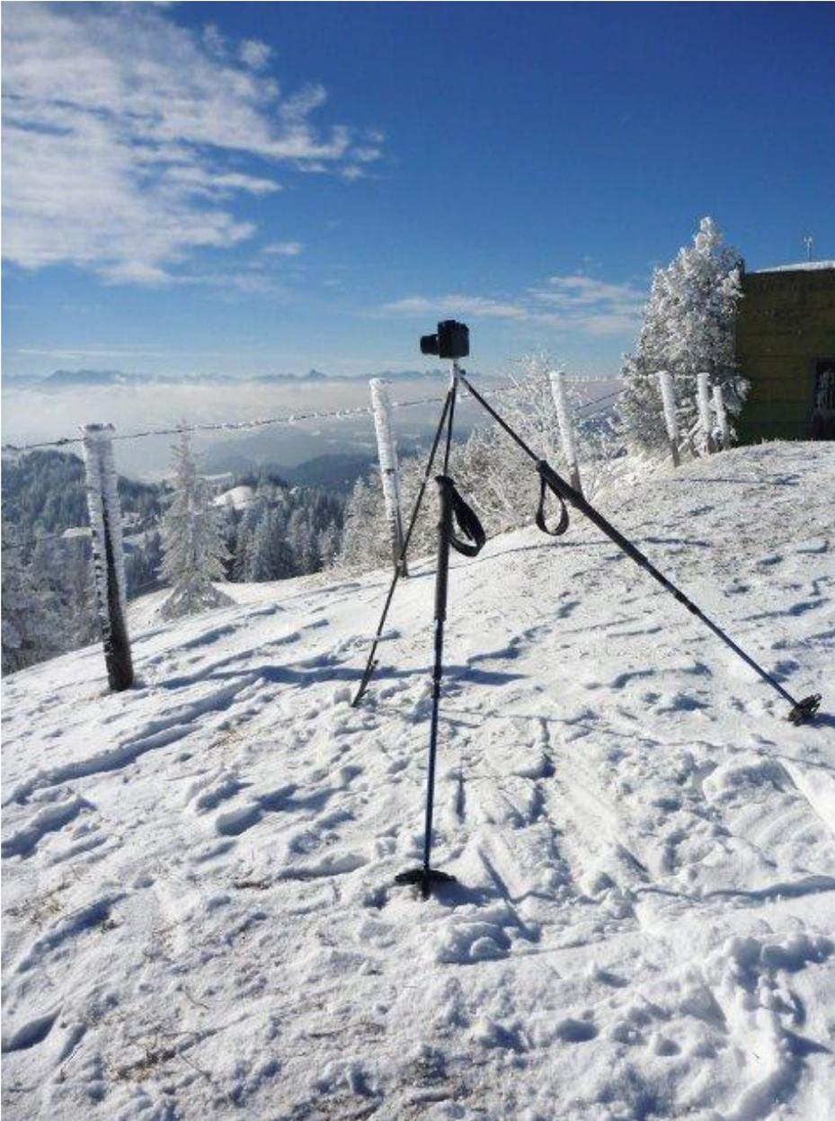
Stativ klein mit Stöcken (bei 3 Segmenten Stativhöhe verstellbar mit Spreitzung der Stativbeine 73-82cm):
