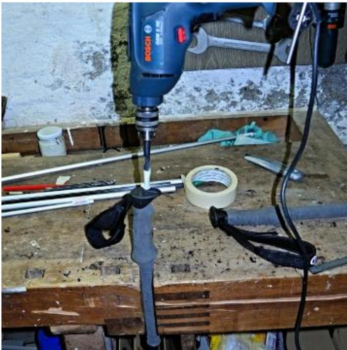
In diese zwei Bohrungen klebe ich mit dem Araldit je ein  $\text{\O}10,0 \times 8,0 \text{mm}$  Aluminiumrohr mit der Länge von 27mm.
